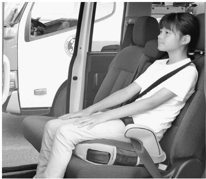
ブラスターシートを使用すると、肩と腰骨の低い位置に正しくベルトがかかっている
