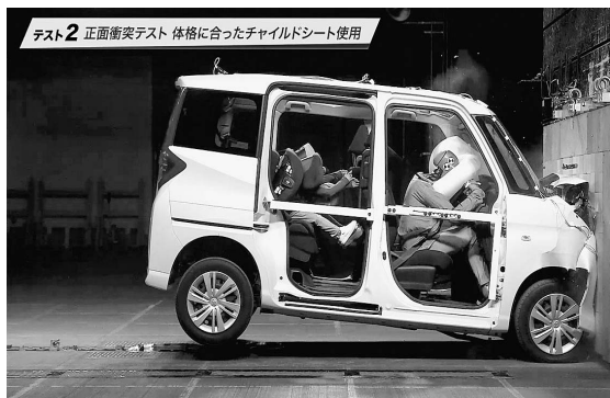
ブラスターシートを使用すると、肩と腰骨の低い位置に正しくベルトがかかっている
