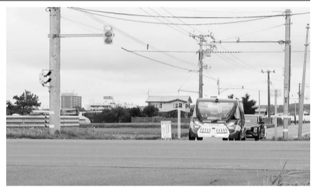
交差点にセンサーを新設。信号の色や通行車の情報をバスに通知する
