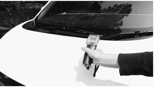
一般的な塗料ではボンネット表面温度が約58度だったが、新塗料では50度以下に
