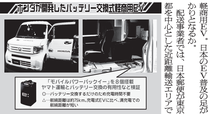
「モバイルパワーバッテリー」を8個搭載。ヤマト運輸とバッテリー交換の有用性など検証。○バッテリー交換するための充電時間不要。△航続距離は約75km。充電式EVに比べ、満充電での航続距離が短い。
