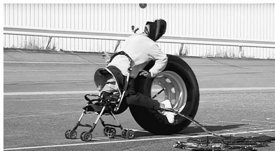
大型車のタイヤは1本100kg近くあり、ぶつかると致命傷にもなりかねない(国土交通省のYouTubeチャンネルより)
