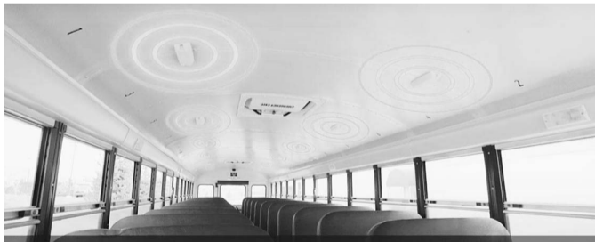
三洋貿易が来年にも発売を予定しているルクセンブルク・I E E社の車内用幼児置き去り検知センサー。バス用と乗用車用がある
