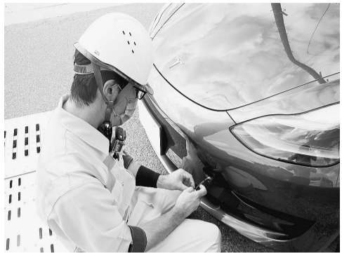
補機バッテリー上りの際、テスラはけん引ボルト開口部のケーブルに通電してボルトを開放できる
